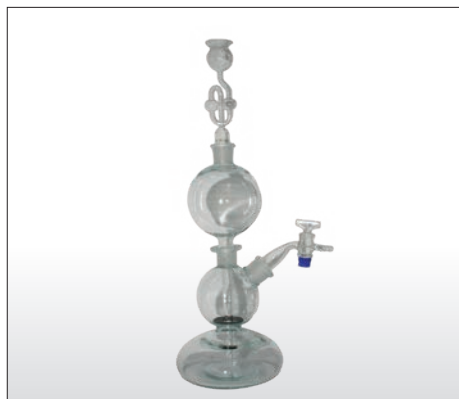
Chlorgasentwickler nach Kipp
