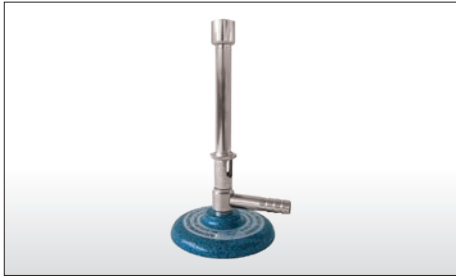
Bunsenbrenner mit Luftregulierung
